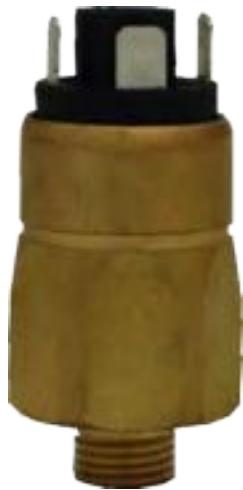
Presostato tipo diafragma con conexión terminal 6,4mm, SPDT, cuerpo de bronce y 80bar de presión máxima de seguridad
