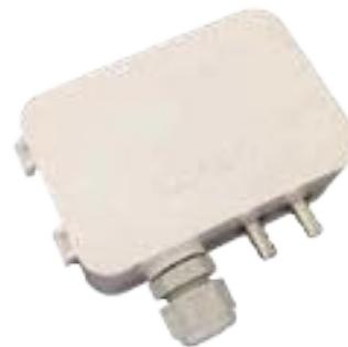
El transmisor de presión diferencial ITAM108 detecta la presión diferencial o la presión manométrica y luego convierte esta diferencia de presión en una señal de salida analógica proporcional. Se ofrecen dos versiones de salida: salida de voltaje de 0 ~ 10 V CC y una salida de corriente de 4-20 mA. El transmisor de presión diferencial LFM108 varía de 0 ~ ± 50Pa a 0 ~ ± 10000Pa.
